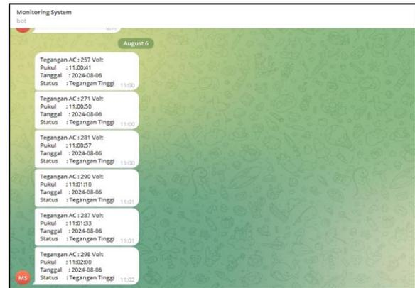
**Gambar 12. Dashboard Monitoring saat tegangan tinggi**
