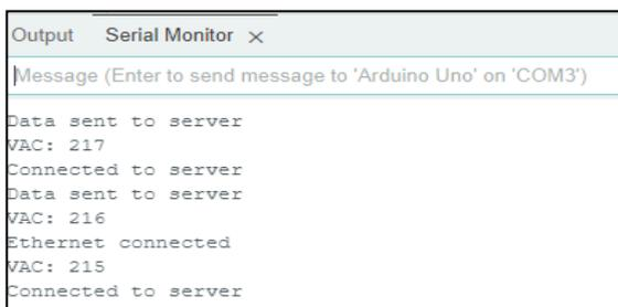
**Gambar 26. Tampilan Serial Monitor saat perangkat sensor bekerja**
