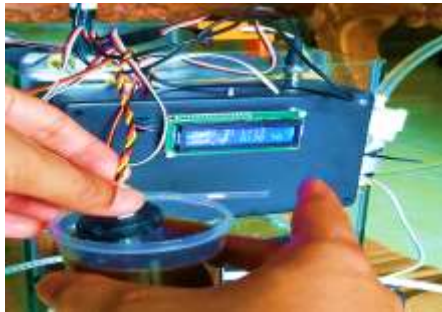
Gambar 18. Sensor Turbidity dengan Air Kotor
