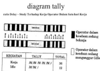
Gambar 2.1. Ratio Delay-Study Terhadap Kerja Operator dalam Satu Hari Kerja
