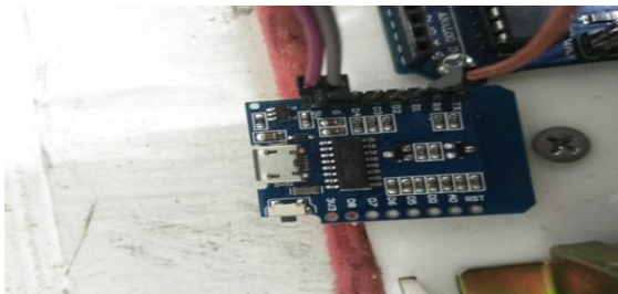
Gambar 10 Pemasangan Mod Wifi ES
