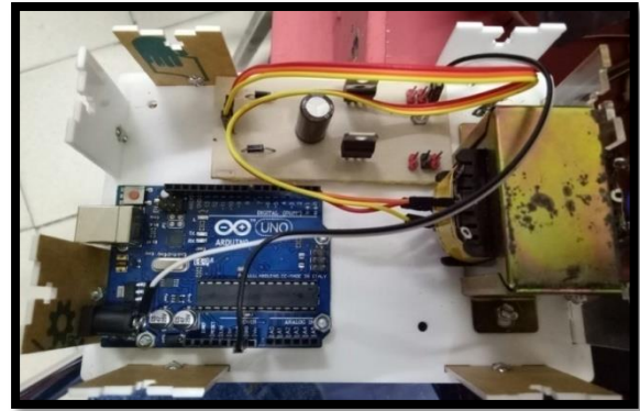
Gambar 7. Pemasangan Mikrokontroler Arduino Uno
